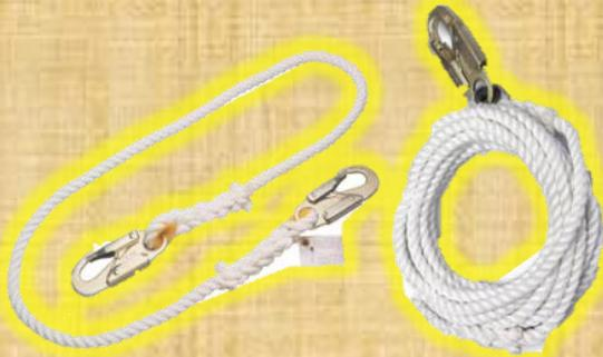
la línea de vida o de posicionamiento con cuerda nylon trenzada de 1/2", es un aditamento de conexión en el equipo de protección personal, de posicionamiento o de sistema de restricción. se utiliza para conectar al usuario a un punto de anclaje, de conexión, o de restricción de caída en cuerda.
