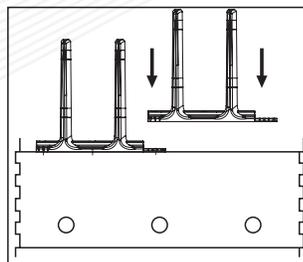
Marque sus barrenos usando la paleta como guía, perforo con broca de 1/4" a 2" de profundidad, coloque los taquetes. Con la ayuda del martillo de unos golpes para que entre bien el perno.
