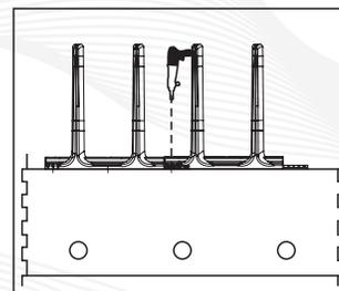
Coloque la paleta en posición, haga el disparo con el perno de 1/4", en cada 1 de los 3 barrenos, use la paleta como guía; coloque su rondana y tuerca.
