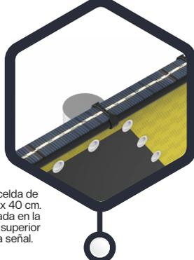
Fotocelda de 4 cm. x 40 cm. montada en la parte superior de la señal.
